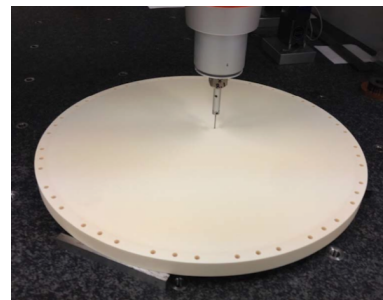
図 5: アルミナレンズの実測の様子。CMM を用いて測定を行った。
