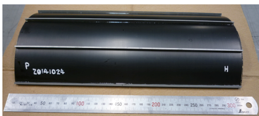
図 5: 梁の貼り付けの様子
