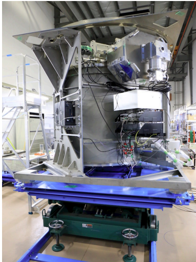
図 2: SWIMS の全体像。デュワーの上部に搭載されているのが MOSU。
